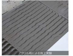
CSP工法で作り出すハニカム型または段ボールに近 い構造体は、在来工法に比べて圧縮や曲げに対して 耐力が安定するため、不具合を生じにくい
